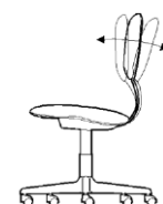
Figura 4.2.3. La inclinación óptima para el respaldo depende del tipo de tarea. Las tareas de trabajo sobre la mesa exigen posturas más erguidas, mientras que muchos operadores informáticos prefieren trabajar con el respaldo algo abatido.
