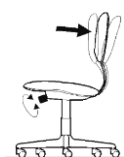
Figura 4.2.4. Si su silla dispone de respaldo con contacto permanente, debe ajustar la tensión del respaldo. Busque el mecanismo de regulación (generalmente un tornillo debajo de la parte delantera del asiento) y apriételo o aflójelo hasta que el respaldo quede a su gusto.
